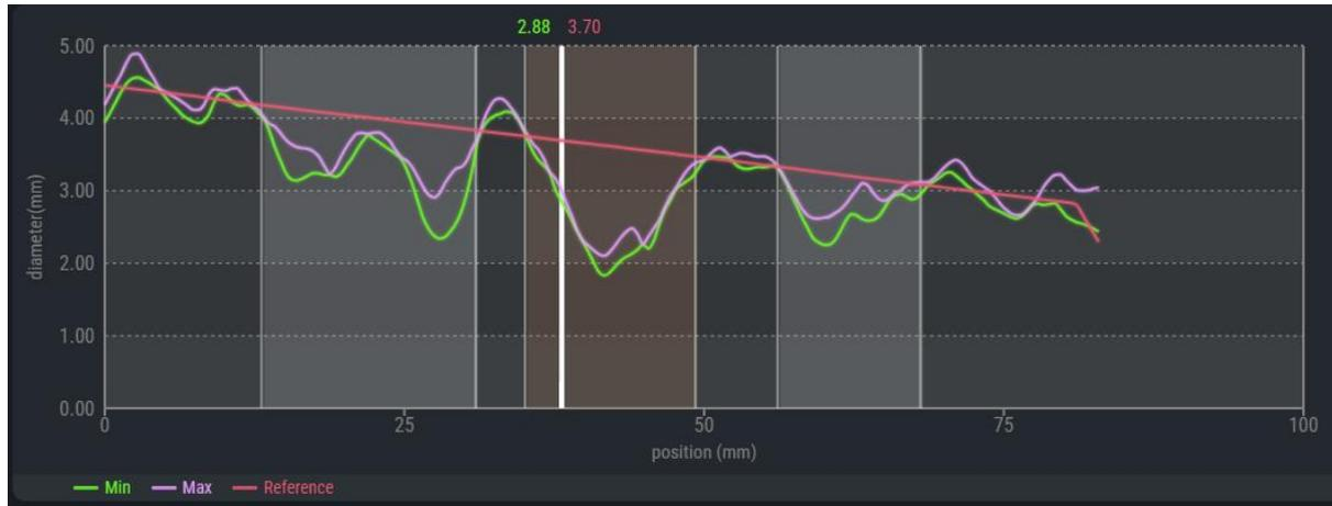
直径グラフには「インデックスマーカー」も白色で表示されます。インデックスマーカーでの最小径とリファレンス径の値は、マーカーの上部に表示されます。マーカーをクリックし、標的血管の全長にわたってドラッグできます。
