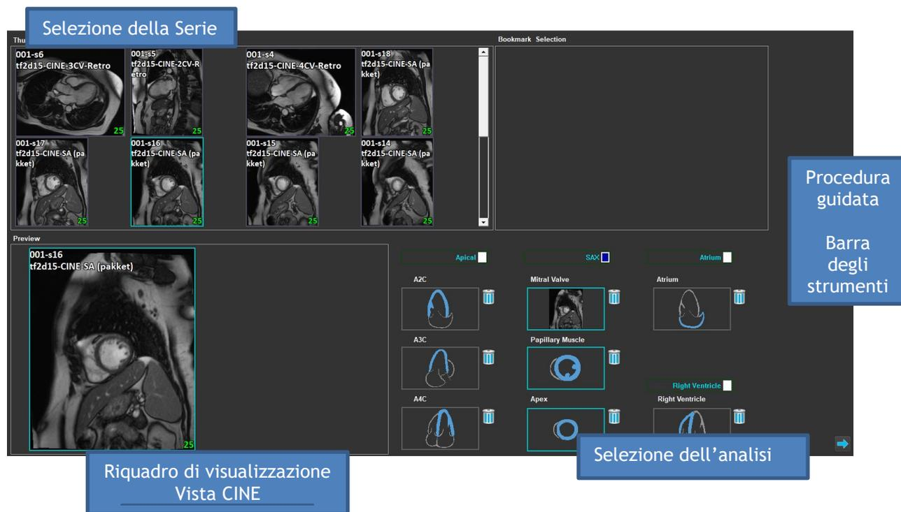
QStrain legge sia i dati della RM sia quelli della TAC. Consente 4 diversi tipi di analisi: Apicale (LAX), SAX, Atrio e Ventricolo Destro. Ogni strato può essere assegnato al blocco appropriato, a seconda del suo orientamento e dell'analisi da eseguire.
