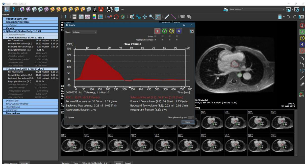
Abbildung 23 QFlow2D mit der Flussanalyse
